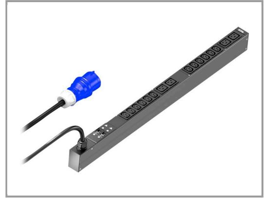
Rittal PDU Basic - Stromverteilungseinheit (Rack - einbaufähig) - Wechselstrom 230 V - 7.4 kW - 3 Phasen - Ausgangsanschlüsse: 16 (4 x IEC 60320 C19, 12 x IEC 60320 C13) - 0U - 3 m Schnur
